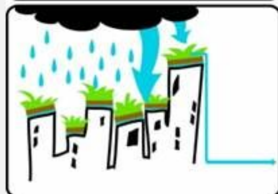
Figura 82: Esquema de enchentes e manejo de enxurradas, diferenciando o telhado comum, do verde.
